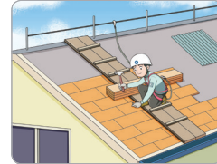
▶ 작업발판 설치 및 안전대 착용
